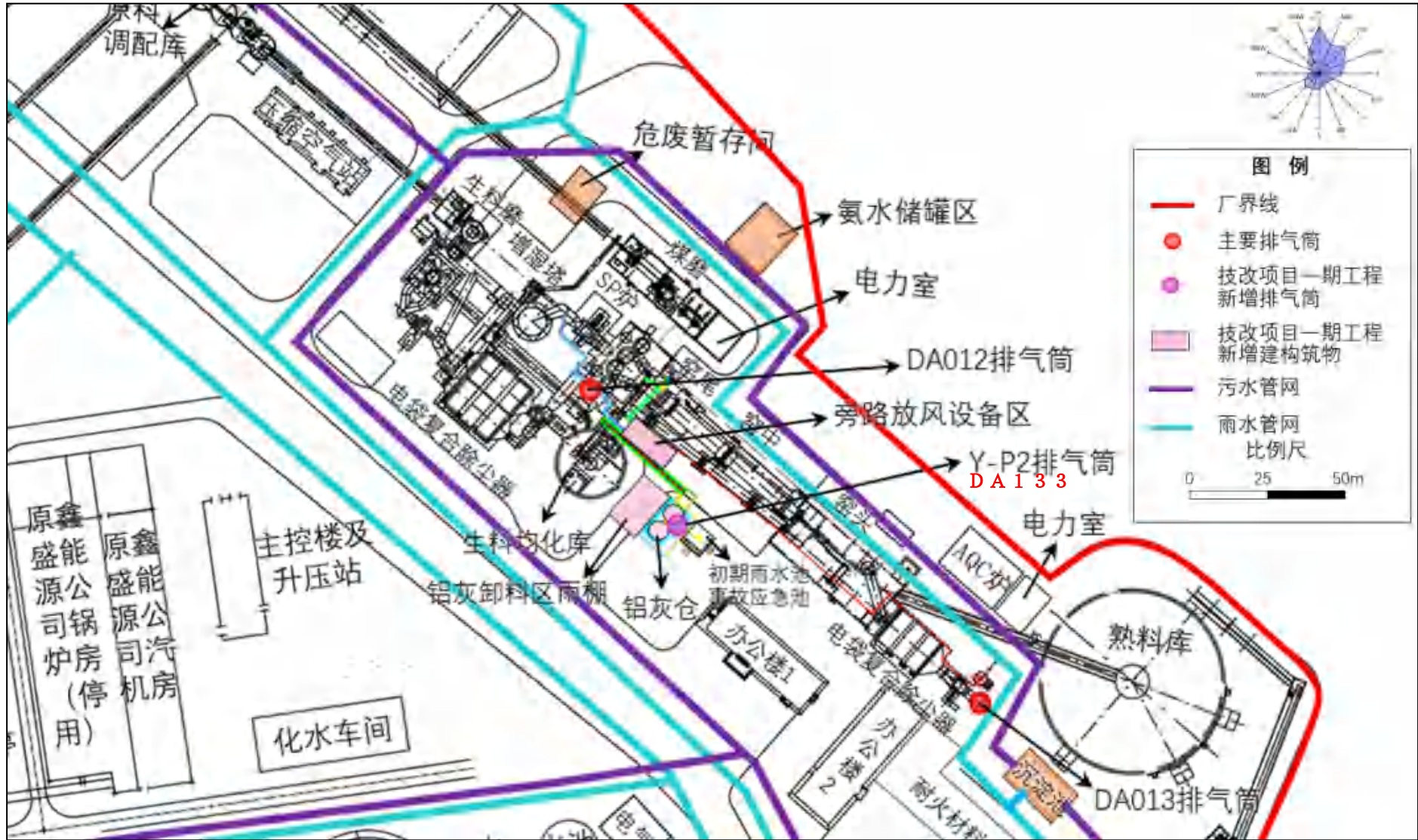
图 3.1-3b 水泥窑协同处置铝灰项目平面布置图（鑫达技改项目一期工程）
